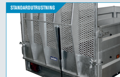
Forstärkt 135 cm hög bakramp och invändiga surrningsögler. Gasdämpare är tillval.
