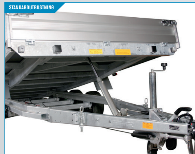
Tipp med kraftig infästning och manuell handpump. Säkert och stabilt.
