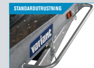
STANDARDUTRUSTNING Cyklistskydd för säkerhets skull. Kan också användas som fotsteg.
