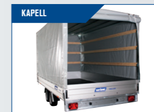
Kraftig kvalitet med öppning i sidan och bak. Invändig höjd 205 cm.
