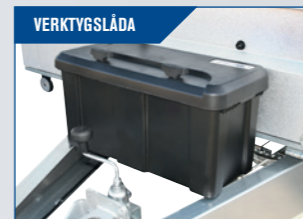
Kraftfull modell med inbyggt lås. Monterad på dragstången.
