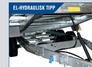
El-hydraulisk tipp med kablet fjärrkontroll.
