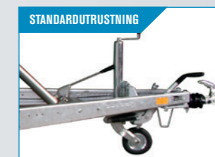
STANDARDUTRUSTNING Hydraulisk tipp och stödhjul. Flaket pumpas enkelt upp, och hålls i tippat läge.
