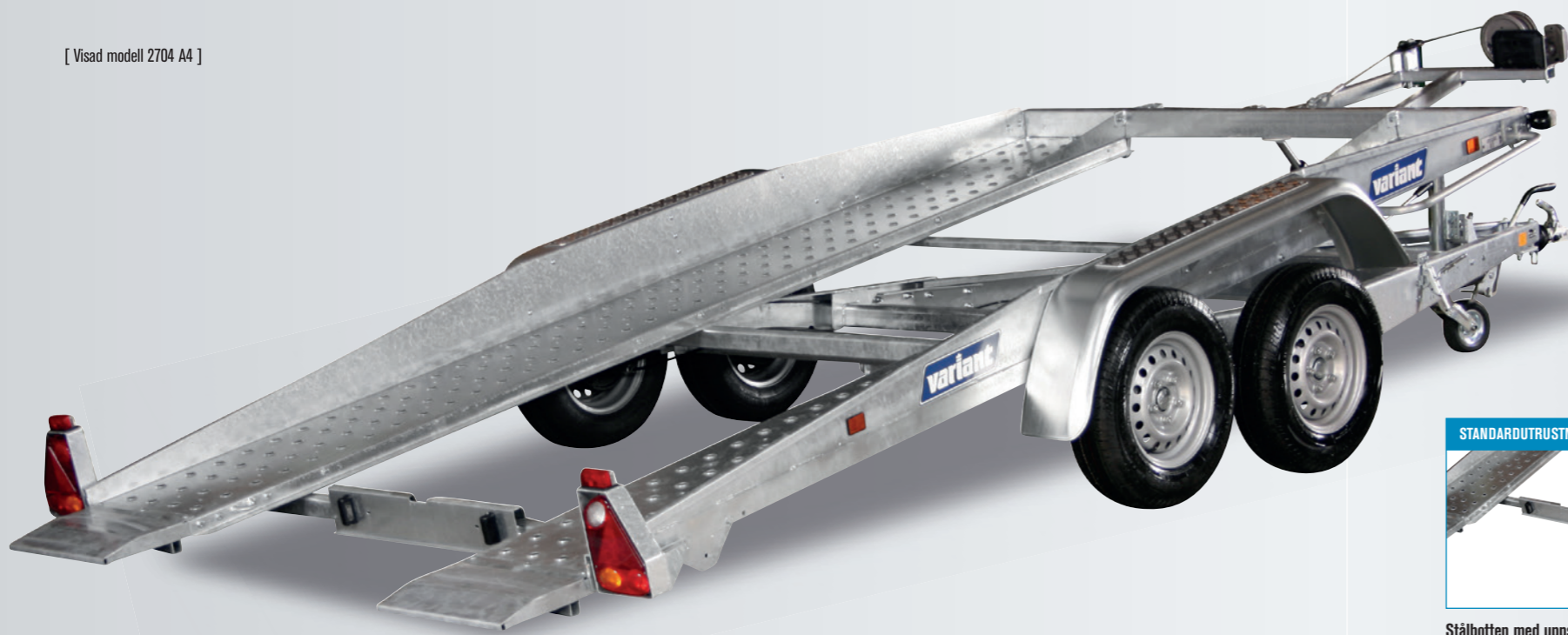
STANDARDUTRUSTNING Stålbottnen med uppskjutande hål. Stark och halksäker.
