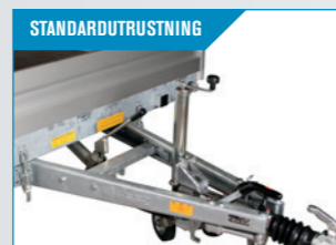
Tippstödshjul, pump till hydrauliken, och kraftig kulkoppling.
