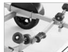
Anpassa trailern med höj- och sänkbara, samt flyttbara sidorullar och körrullar.
