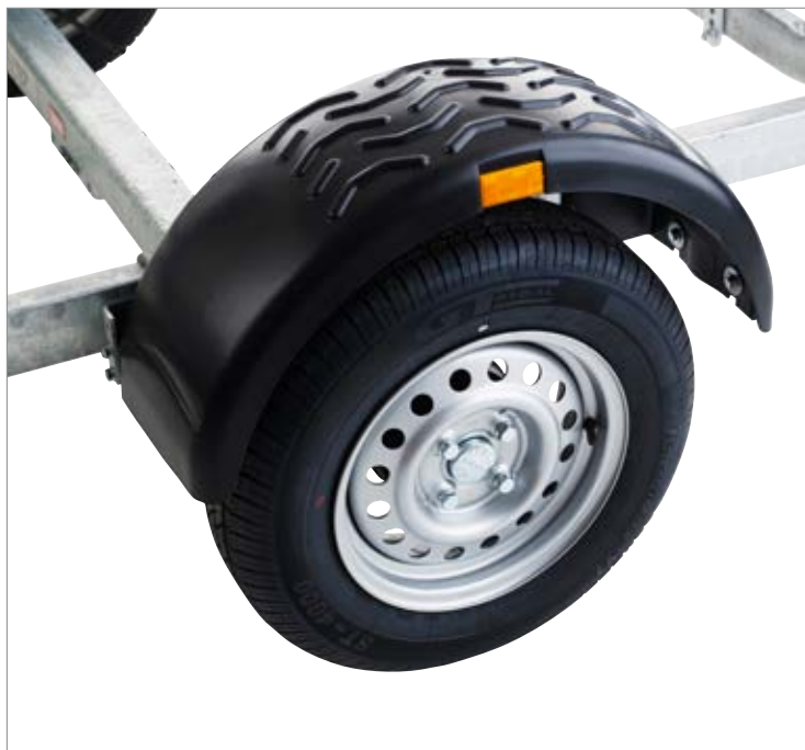
Standardhjul. Skärmar finns som tillbehör (ej till dubbla axlar).
