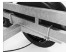
Genom att flytta hjulaxeln kan du fördela vikten optimalt.
