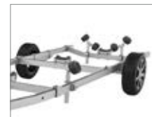
Anpassa trailern med höj- och sänkbara, samt flyttbara sidorullar och kölrullar.
