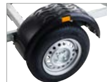
Ståbara och heltäckande skärmar som skyddar mot vägsprut.
