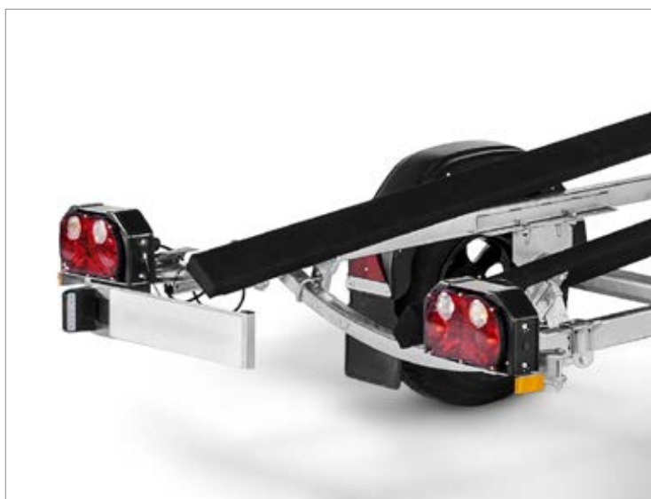
Snygg och smidig belysning bak. Två vattentäta och vikbara ljusenheter för enkel av- och pålastning. Sjösättning kan göras utan att belysningsarmaturen avlägsnas.
