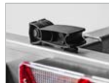
Ljusramp med quick-release-fästen.
