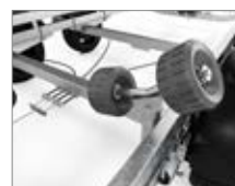
Dubbla multijusterbara X-line-sidorullar.
