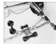
Dubbel självjusterande vagger.
