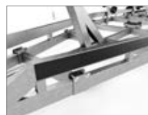
Förstärkt svetsat chassi.
