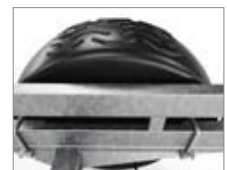
Ståbara och heltäckande skärmar som skyddar mot vägsprut.
