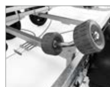
221300B SVX är utrustad med dubbla sidorullar.
