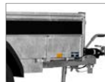
Svetsad trailer med förstärkt varmgalvaniserat chassi.
