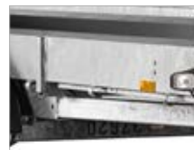
Svetsad trailer med varmgalvaniserat chassi.
