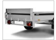
Högre bakläm som uppköringsläm klädd med räfflad alu.plåt.
