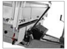
Hydraulisk tippfunktion är standard, inkl. manuell nödpump.
