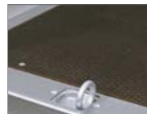
Infällda bindöglor på lastplattformen.
