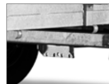
Utrustad med invändiga bindöglor och utvändiga bindkrokar.
