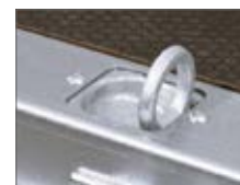
Nedfällda bindöglor, roteras 45 grader för drag.
