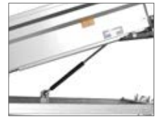
Gasfjädertipp är tillval, skruvtipp är standard.
