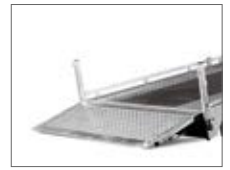
Tipp och låg rampvinkel gör det enkelt att lasta maskiner.
