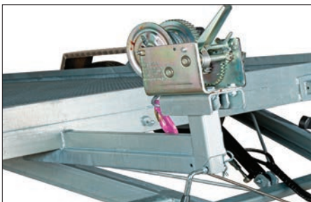
Vinsch och vinschhorn Underlättar vid på- och avlastning, används på större trailers
