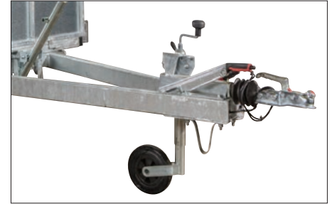
Stödhjul komplett Underlättar kopplingsmomentet samt manövreringen av trailern
