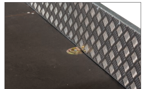
Aluminiumklädd insida Förstärker och skyddar lämsidan
