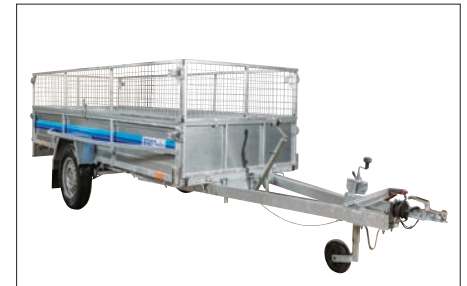
Nätlämsats komplett höjd 40 cm Ökar lastvolymen, både fram- och bakgrind är vikbara med gångjärn, för enklare hantering
