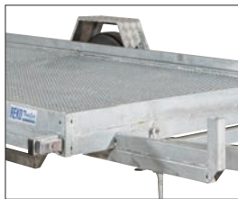
Odämpad tipp och fäste för vinsch och vinschtorrn
