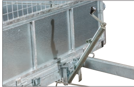
Skruvtipp Tippar trailern stegvis samt i en mjukare och jämnare rörelse
