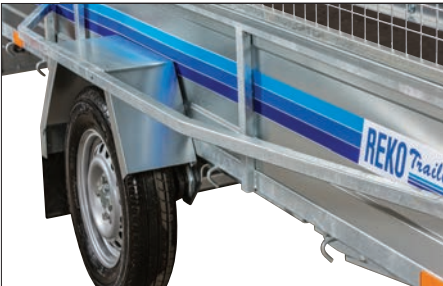
Avbärare till plåtskärmar Skyddar plåtskärmen och lämsidan mot påkörning
