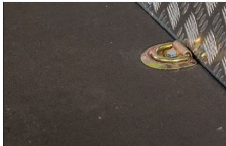
Surningsögla flakmonterad Profil som monteras i flakskivan, säkrar lasten under färd i kombination med spännband
