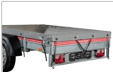
Kapelllock Skyddar lasten mot regn och smuts, gummistropparna spänner presenningen på lämmarna
