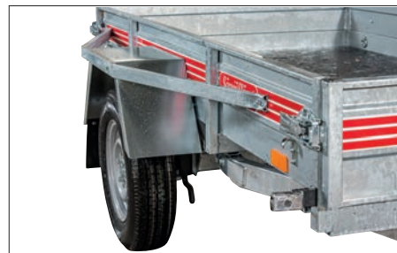
Avbärare till plåtskärmar Skyddar plåtskärmerna och lämsidan mot påkörning
