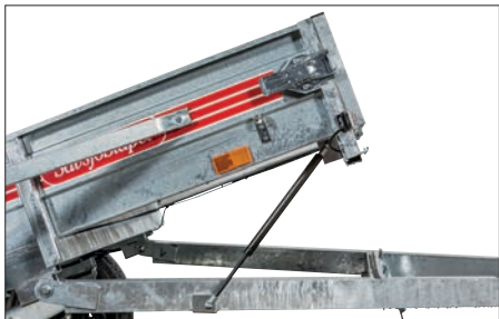
Tippdämparsats komplett Tippar trailern i en mjukare och jämnare rörelse
