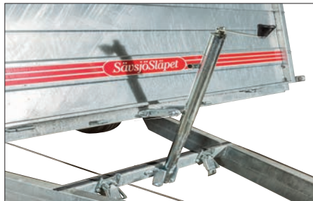
Skruvtipp Tippar trailern stegvis, i en mjukare och jämnare rörelse
