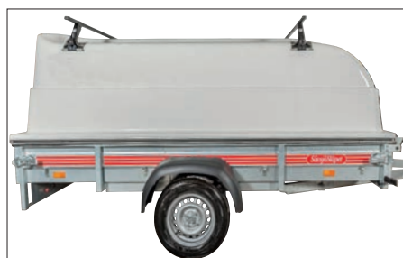
Glasfiberkåpa AERO höjd 75/125 cm Skyddar lasten mot regn och smuts och ökar trailerns lastvolymer, fästena och två gasdämpare i framkant, kåpan är extrautrustad med takräcken
