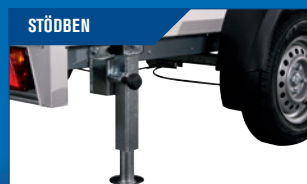
STÖDBEN Kraftigt svängbart stödben ger säker och stabil lastning.
